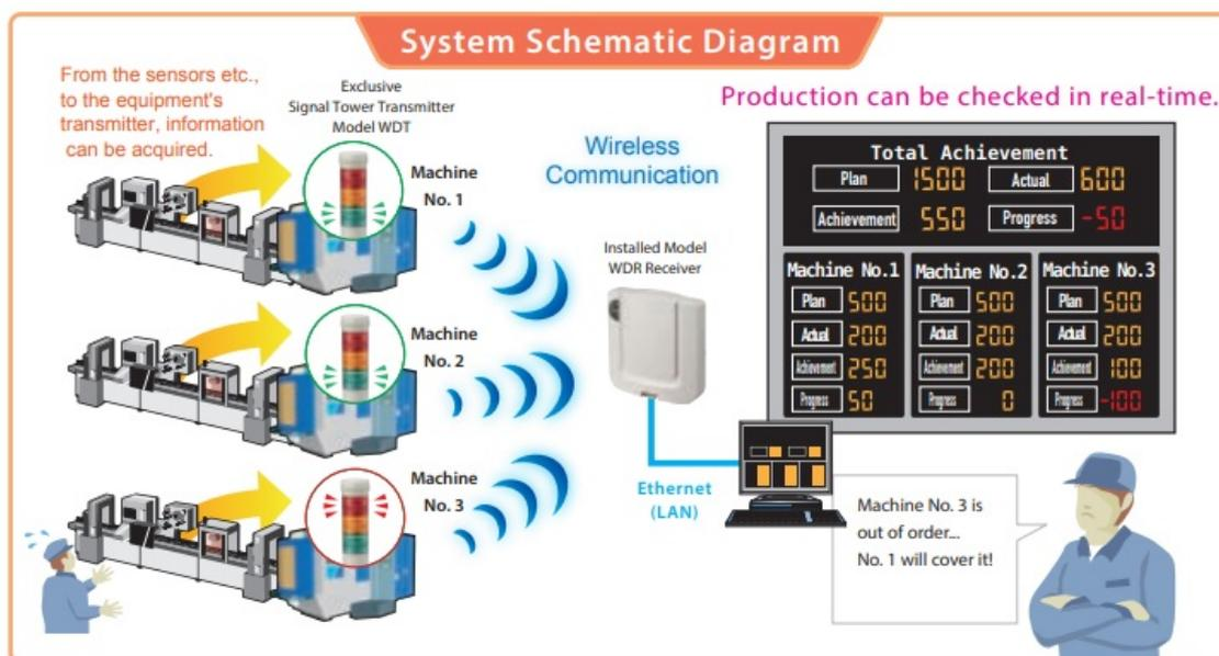
O sistema WD permite que os usuários obtenham, sem fio, dados da máquina remotamente e em tempo real, eliminando completamente os relatórios manuscritos. Os dados coletados são precisos e podem ser usados para determinar a gravidade do problema para uma manutenção preditiva mais eficaz.
